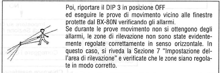
Poi, riportare il DIP 3 in posizione OFF ed eseguire le prove di movimento vicino alle finestre protette dal BX-80N verificando gli allarmi. Se durante le prove movimento non si ottengono degli allarmi, le zone di rilevazione non sono state evidentemente regolate correttamente in senso orizzontale. In questo caso, si riveda la Sezione 7 "Impostazione dell'area di rilevazione" e verificate che le zone siano regolate in modo corretto.
