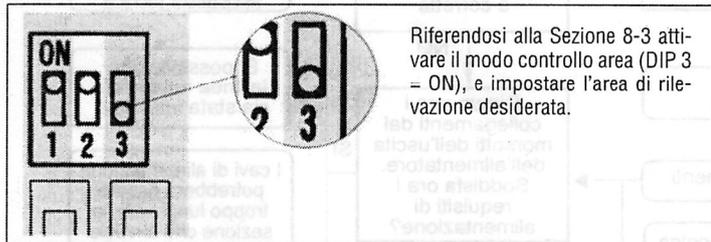
Riferendosi alla Sezione 8-3 attivare il modo controllo area (DIP 3 = ON), e impostare l'area di rilevazione desiderata.
